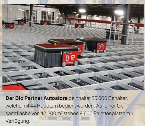
**Der Bio Partner Autostore** beinhaltet 25'000 Behälter, welche mit 44 Robotern bedient werden. Auf einer Gesamtfläche von 12'200m<sup>2</sup> stehen 9'600 Palettenplätze zur Verfügung.
